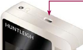
Verbinden Sie das mitgelieferte Ladekabel mit dem USB-Anschluss oben am Doppler.
