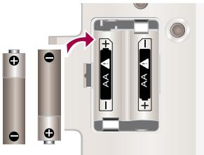
Legen Sie die Batterien mit dem Pluspol voran ein. **Achten Sie auf die korrekte Polarität.**
