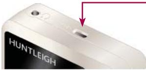
Verbinden Sie das mitgelieferte USB-Kabel mit dem USB-Anschluss oben am Doppler und verbinden Sie es mit dem Computer.
